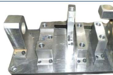
Đồ gá kiểm tra chi tiết – J09 Inspection Jig for part
