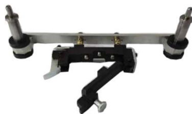
Đồ gá cắt dây điện – J06 Electric wire cutting Jig
