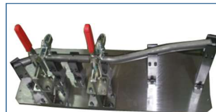
Đồ gá kẹp chi tiết gia công – J11 Clamping Jig for machining
