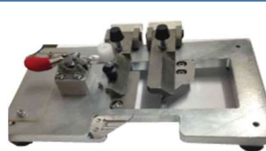
Đồ gá lắp bảng mạch – J07 Board assembly Jig
