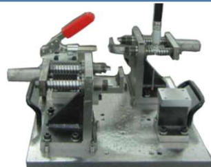
Đồ gá kiểm tra chi tiết – J04 Inspection Jig for part
