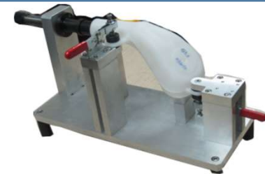
Đồ gá kiểm tra bình xăng – J10 Inspection jig for gasoline tank.
