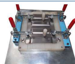
Đồ gá kiểm tra chi tiết – J12 Inspection Jig for part
